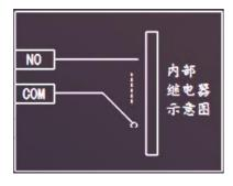
\*继电器耐压 220V, 最大驱动电流 2A
