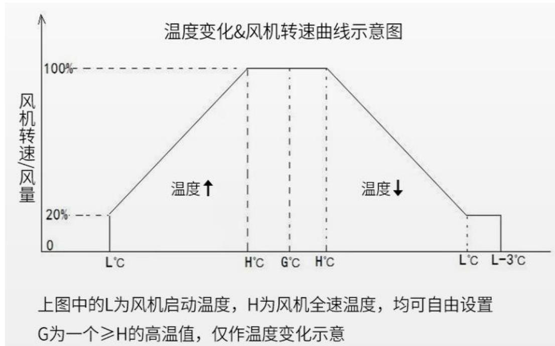
上图中的L为风机启动温度，H为风机全速温度，均可自由设置
