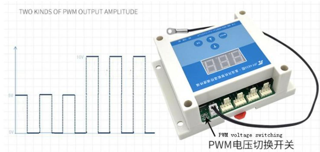
\*如果不确定当前风机需要哪种电压的控制信号来调速，可以先将 PWM 电压切换开关拨至 5V（出厂默认一般也是 5V），如果不能正常调速，再将切换开关拨至 10V 即可。
